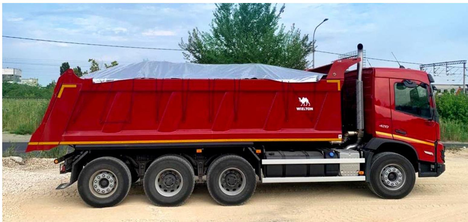
Volvo FH 8x2 420 л.с. с надстройкой «Чибис». Грузовик полностью на пневмоподвеске. Высота над землёй: один метр
